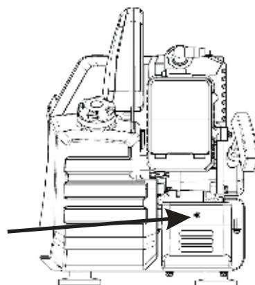
**Примечание:** если возникают затруднения при первоначальном запуске из-за чрезмерного количества бензина, отвинтите свечу зажигания, отсоедините впускную трубку, полностью откройте воздушную заслонку и несколько раз потяните рукоятку стартера, затем присоедините впускную трубку и запустите электростанцию.
